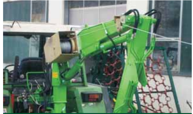
Enroulement propre du câble avec la poulie
