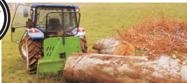
Treuil Pro SEH avec tablier hydraulique et dérouleur
