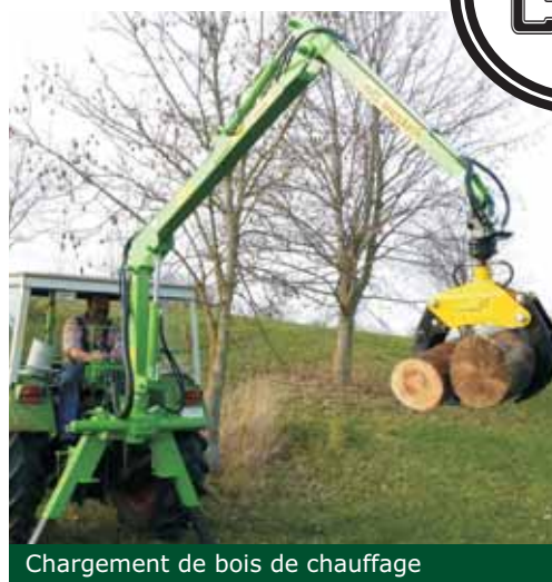
Grue CF 2- la grue de chargement de bois de chauffage idéale pour les petits tracteurs
