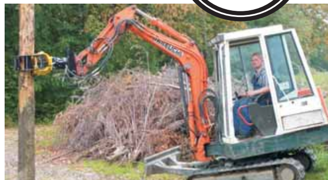
G. à bois en montage fixe pour travaux d'abattage et de chargement
