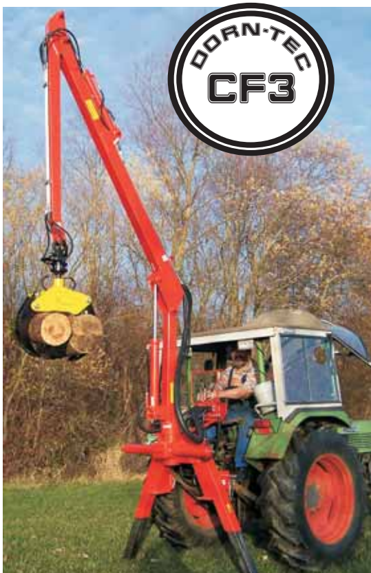
Grue CF 3- pour 3-points et montage sur remorque
