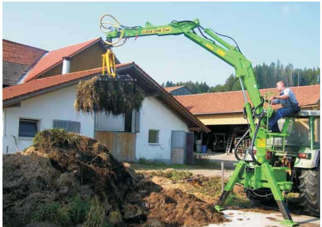
Grue CLN chargement de fumier/Equipement crochet d'attelage réglable
