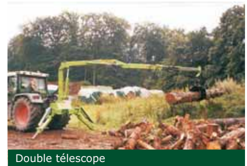
Montage 3-points avec siège sur la grue
