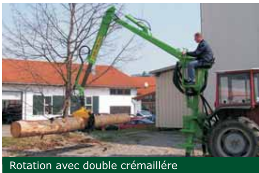
Grue CF avec pompe indépendante au travail en forêt
