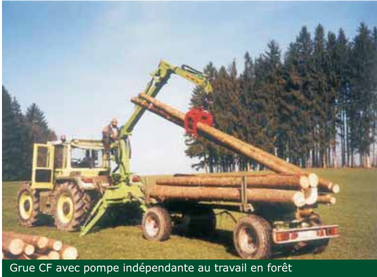
Montage 3-points avec siège sur la grue
