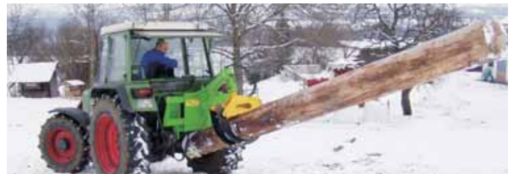
Large débardement avec fixation 3-points intégré
