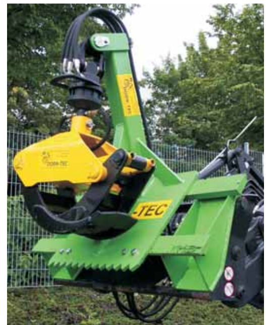
Position de transport avec fixation du grappin
