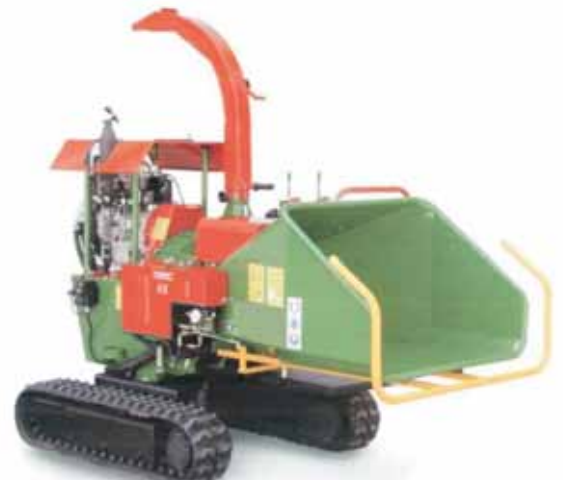
Broyeur avec moteur indépendant et chenilles
