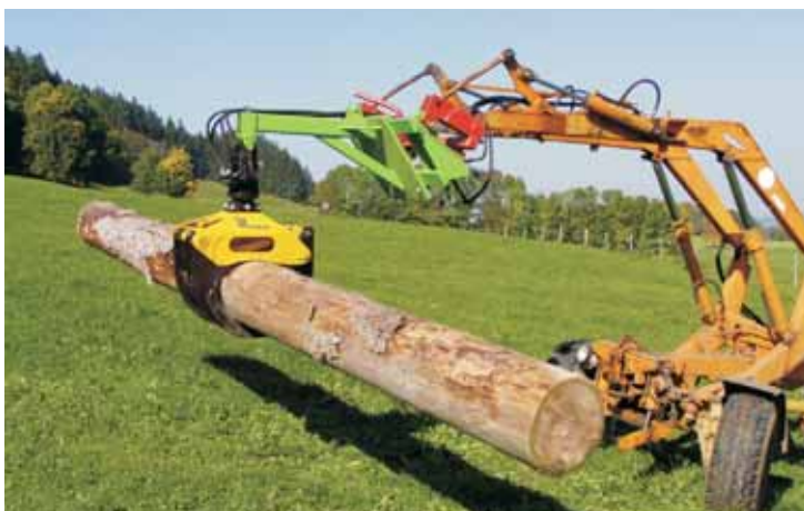
Montage avec rotator hydraulique robuste
