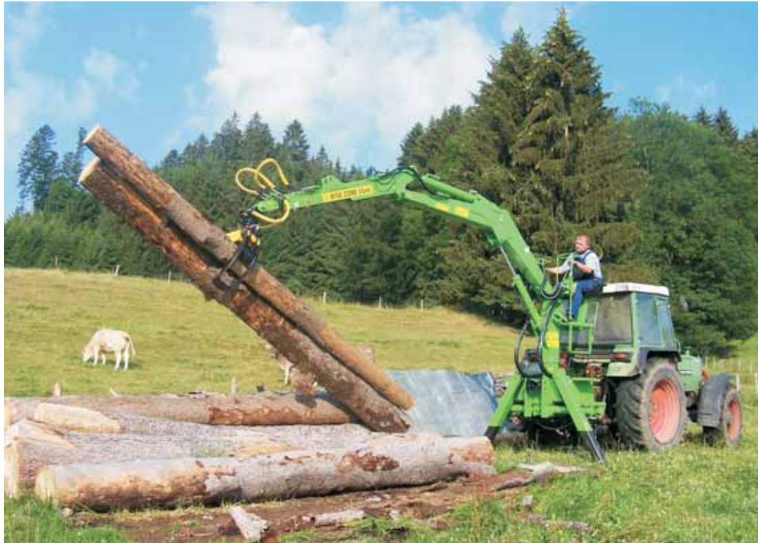
Chargement de bois avec siège sur la grue et commande Confort
