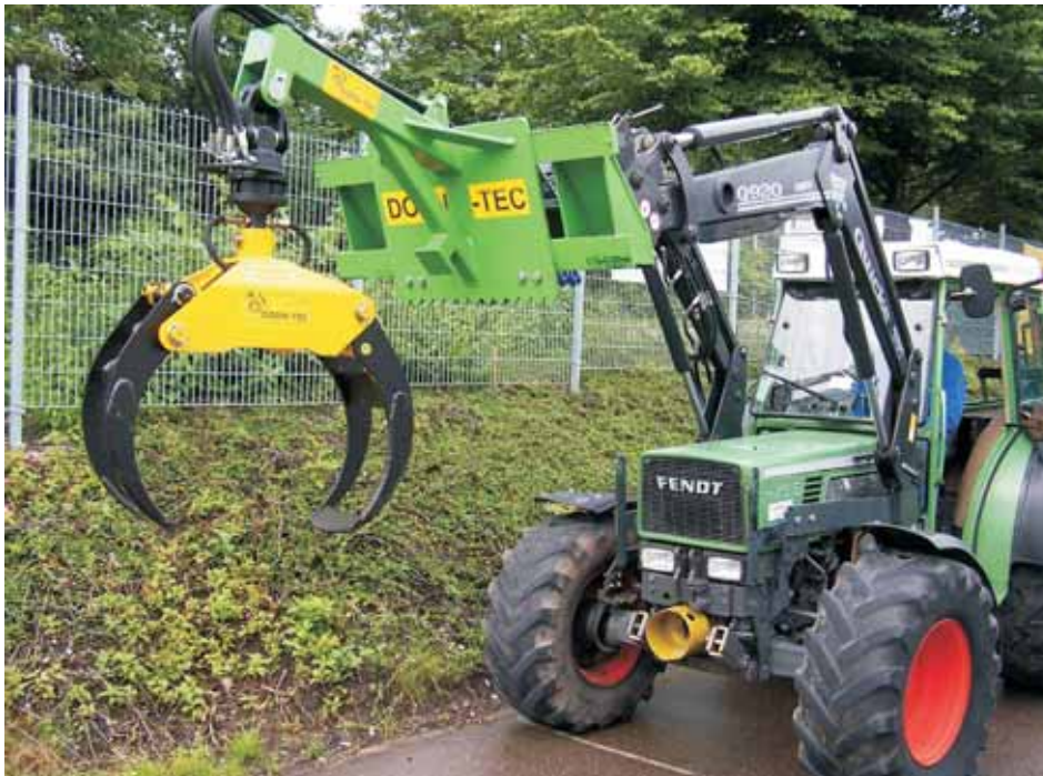
Grappin sur chargeur frontal TopGrip de fabrication allemande
