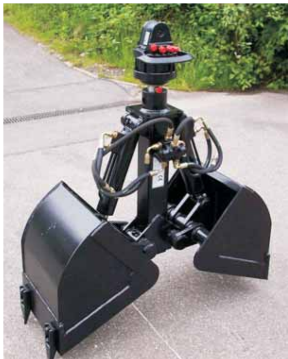
Benne preneuse avec double vérin pour le terrassement
