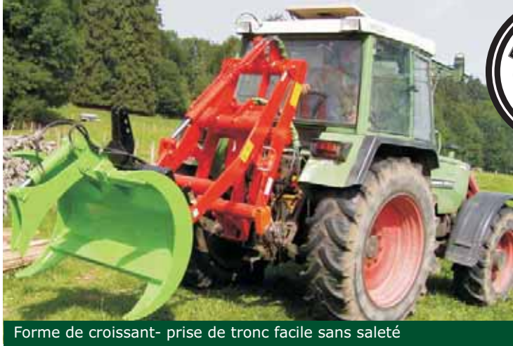
Transport des troncs sécurisé par le bras de maintien hydraulique
