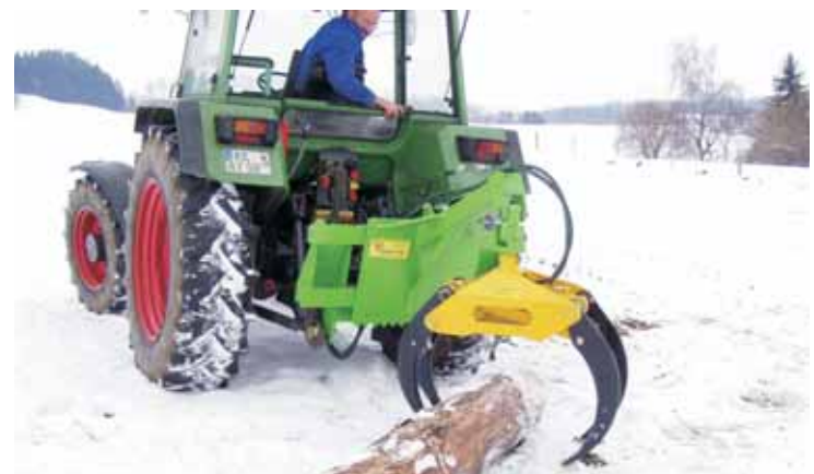
Travaux de débardage avec montage arrière
